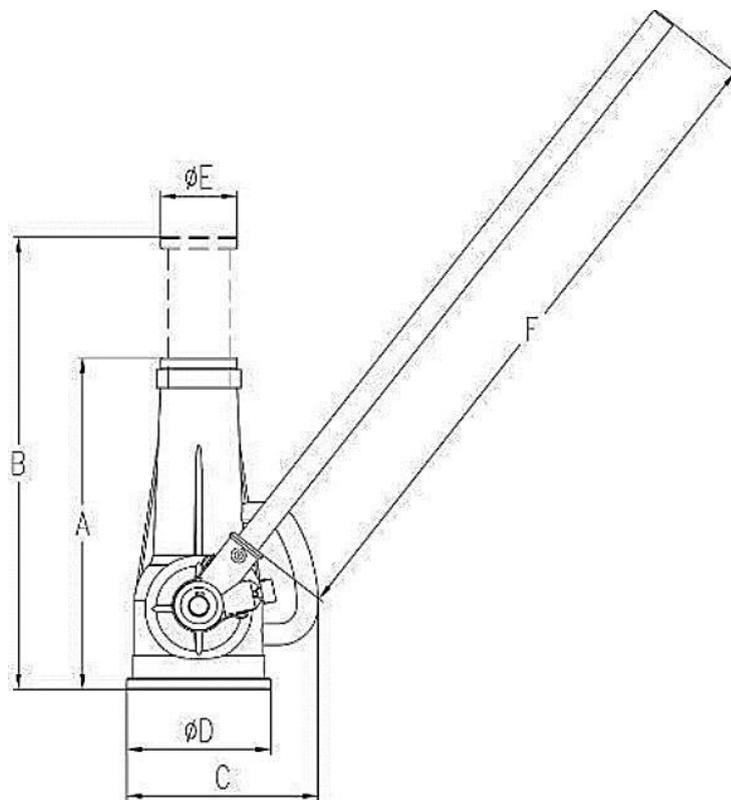
**Принцип работы домкрата** - с помощью взмаха трещотки (храповика) приводится в действие малая коническая шестерня, она в свою очередь заставляет вращаться винт, который приводит в
